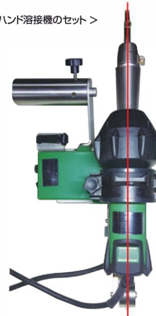
ガイドローラーとノズルの先端が一直線になるようにハンド溶接機をセットしてください。
