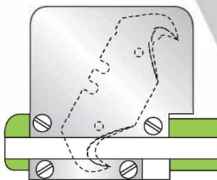
フック刃取付プレートを裏側にして(ピンのある面を外側に向けて)取り付けます。
