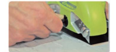
ネジを締めたり緩めたりすることで目地の大きさを調整します。
