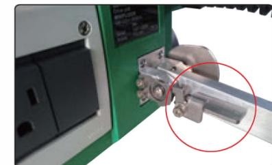
溶接をする際は、上記アームロックを解除してミニフロアを倒して施工してください。
