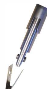
蝶ネジを緩めて軸を前に押し出して、刃を交換してください。
