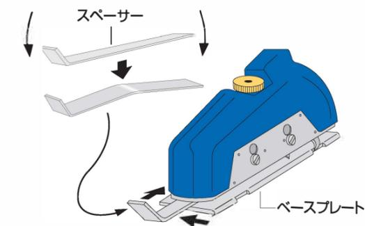
本体とベースプレートとの隙間に挟まるようにスペーサーを軽く曲げ、奥から詰めてスペーサーをセットします。
