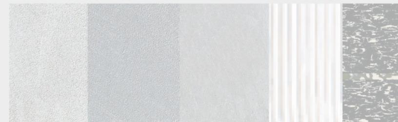
↑ 下地    ↑ プライマー塗布    ↑ S111塗布    ↑ 接着剤塗布    ↑ 仕上材施工
