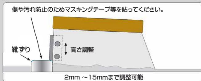
塵をつけたい高さ(左記 a)にプレートに合わせて固定して、靴すり等につ引っ掛けてレベリング、下地補修をする事で塵合わせをします。
