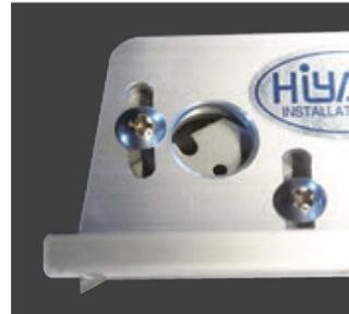
カットする床材の厚みに合わせて刃を調整してください。
