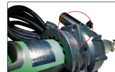
溶接リールを使用しない場合は、上記穴に溶接棒を通して施工してください。
