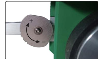
溶接機を下ろして始動させる位置を (+) ... 遅らせる (-) ... 早める
