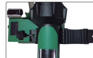
付属のゴム製アダプターをつけることで、旧モデルのトリアックも装着できます。
