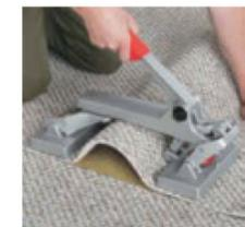
ヘッド部分のノブを右へセットすればハンドルを下ろすときにほぼ 6.5mm 毎にカチカチッとハンドルがロックされますので手を離してジョイント作業などができます。通常の状態に戻すにはこのノブを左 (OFF) にセットします。
